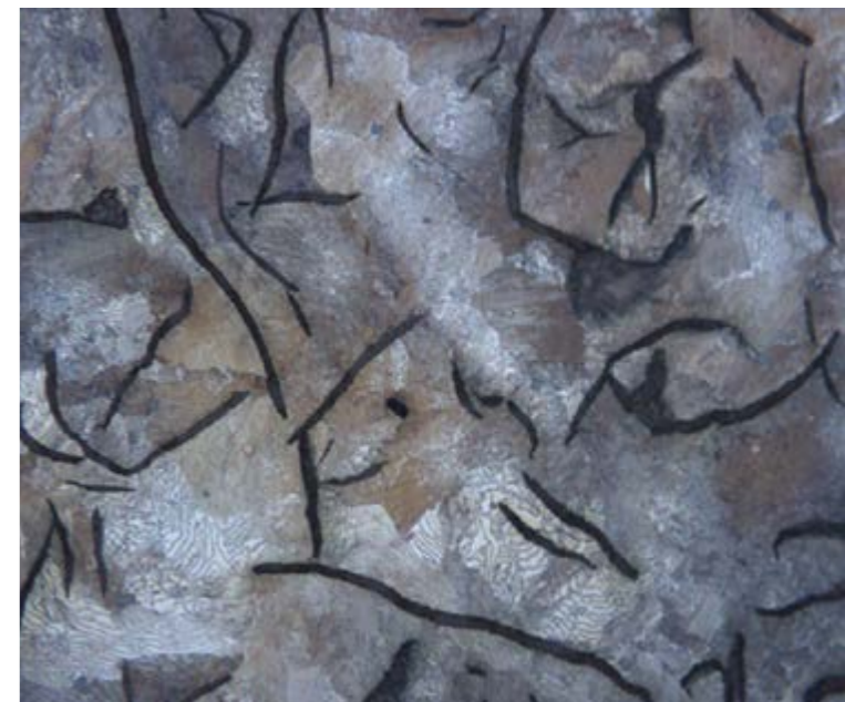
Slika 4: Mikrostruktura litega železa z lamelarnim grafitom
