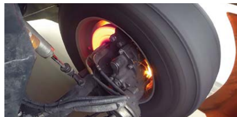
Slika 2: Visoke temperature povzročajo, da zavorni disk žari
