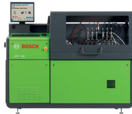
Стенд для діагностики системи Common Rail EPS 708 з інтегрованою системою охолодження
