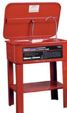
Стаціонарна мийка частин електрична з ємністю 50 л
