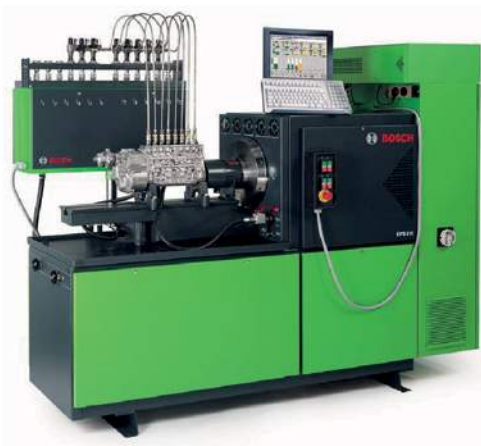
Стенд для діагностики дизельних паливних систем EPS 815
