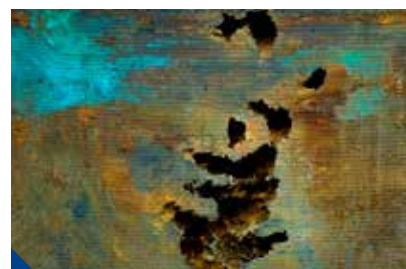
Głębokie wżery na części mokrej tulei - następstwo procesu kawitacji
