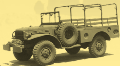
W czasie II wojny światowej wszystkie armie korzystały z pojazdów z napędem wieloosiowym – na zdjęciu Dodge T2 (1942- 45) w służbie armii amerykańskiej.
