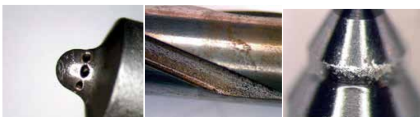
Рис. 3. Пошкодження функціональних елементів розпилювача: 1 — деформація розпилювальних отворів, 2 — корозійна втома голки, 3 — пошкодження діаметра сідла голки.
