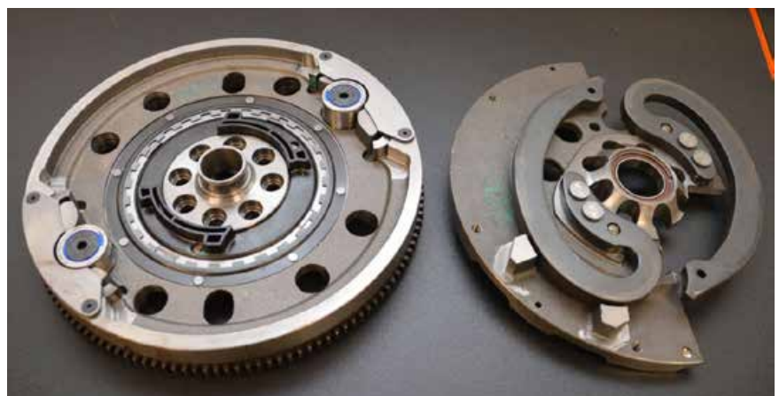
Двомасове махове колесо Valeo VBLADE в розібраному стані із спеціальними пластинчастими пружинами
