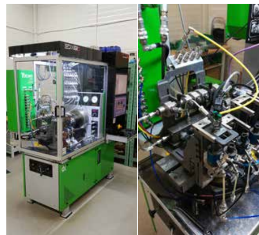
Рис. 5. Стенд для перевірки характеристик форсунок Common Rail та проєкція форсунки, встановленої у зажим випробувального стенда.
