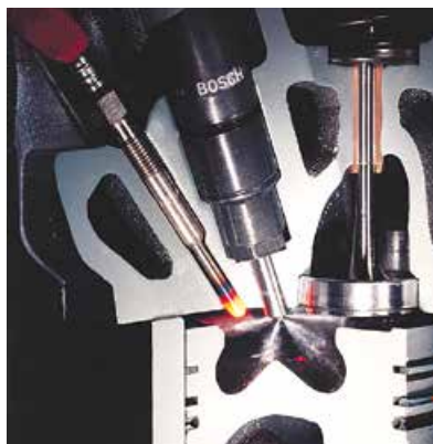
Рис. 2. Впорскування розпиленої дози палива в камеру згоряння за допомогою форсунки CR.
