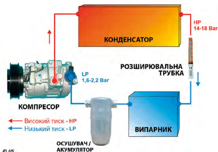
Рис. 2. Система кондиціонування з розширювальною трубкою
