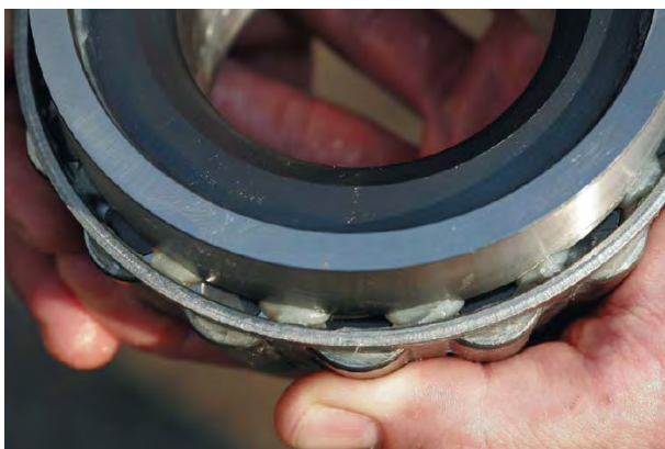
Рис. 2. Нанесення мастила на підшипник маточини
