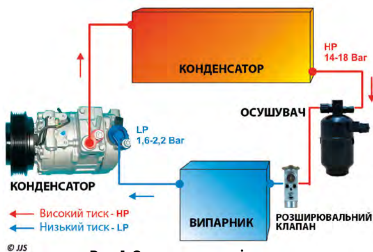
Рис. 1. Система кондиціонування з розширювальним клапаном
