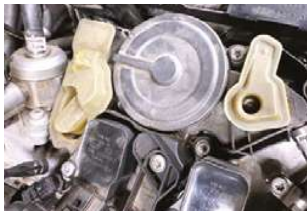
Рис. 3. Паливний насос високого тиску з клапаном регулювання тиску палива у двигуні 1,8 TFSI
