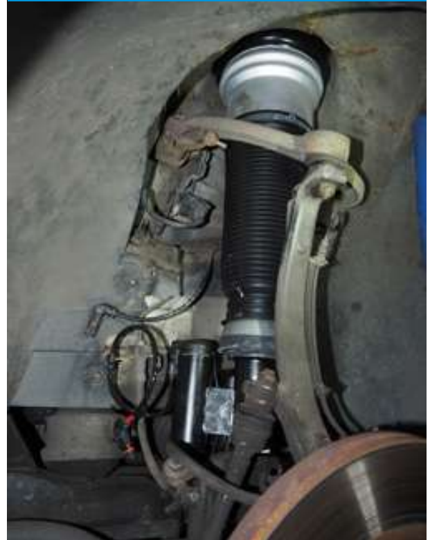
Рис. 2. Нова деталь встановлена правильно і буде коректно працювати. Пневмомодуль опирається на втулку
