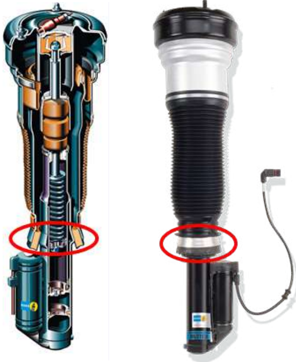
Рис. 3. Старий пневмомодуль, втрачено герметичність системи (ймовірно ресурс уже вичерпано остаточно, або ж він близький до критичної межі). Варто перевірити підвіску, замінити всі зношені деталі
