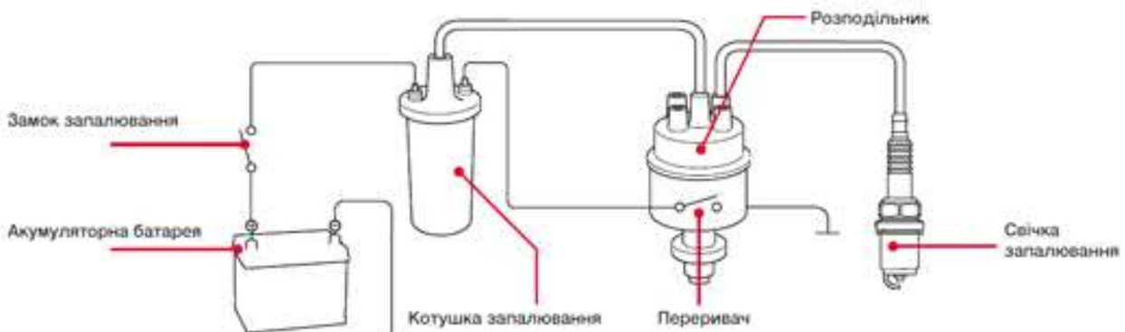
Рис. 1. Основні компоненти системи запалювання Кеттерінга
