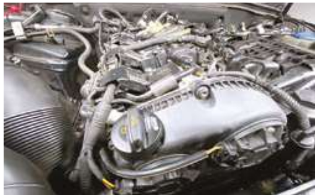
Рис. 1. Двигун третього покоління 1,8 TFSI, видимі електромагнітні стабілізатори ГРМ (впуск і випуск), розташовані в кришці приводу ланцюга ГРМ
