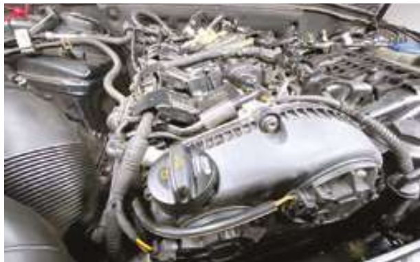
Рис. 1. Двигун третього покоління 1,8 TFSI, видимі електромагнітні стабілізатори ГРМ (впуск і випуск), розташовані в кришці приводу ланцюга ГРМ
