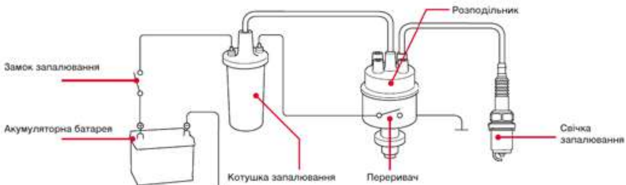
Рис. 1. Основні компоненти системи запалювання Кеттерінга
