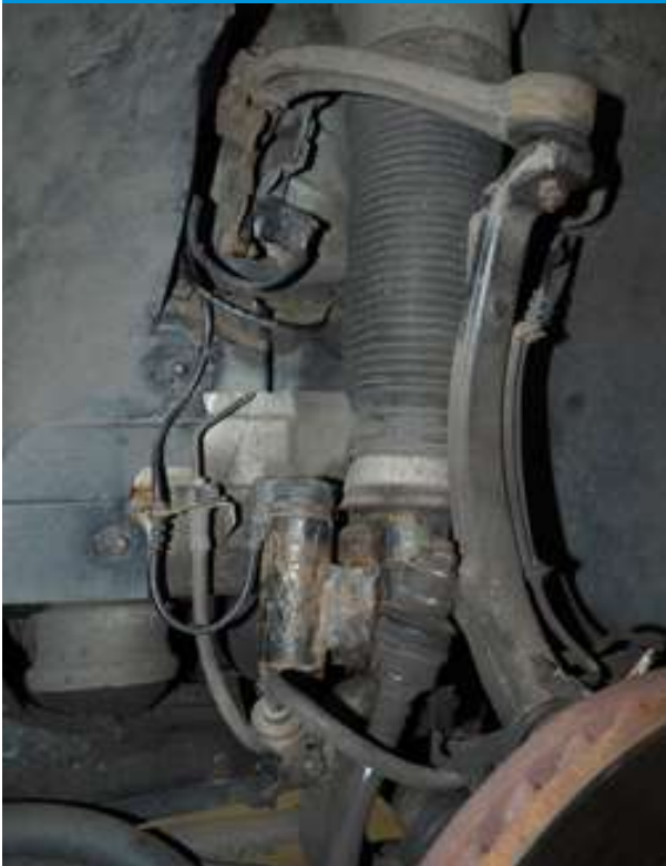
Рис. 3. Старий пневмомодуль, втрачено герметичність системи (ймовірно ресурс уже вичерпано остаточно, або ж він близький до критичної межі). Варто перевірити підвіску, замінити всі зношені деталі
